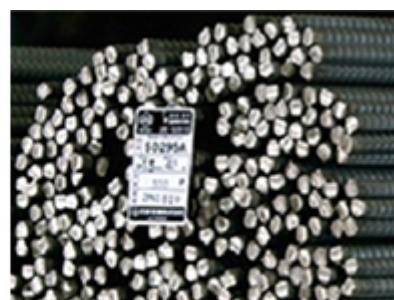
リサイクルされた鉄筋
