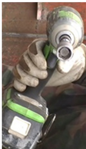
インパクトドライバーのソケット内に強力な磁石を埋め込んだ治具
