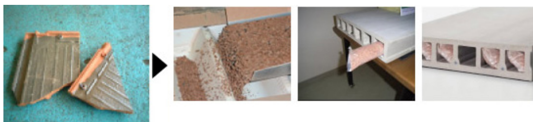
瓦の端材を床の衝撃音緩衝材として使用
