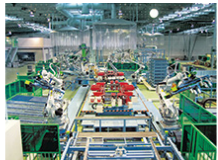
多品種の軸組を「完全邸別生産」できる自動化ラインは住宅業界初
