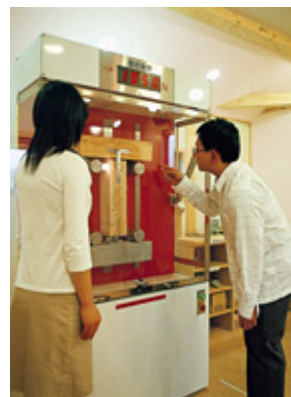
在来工法の木造住宅と「シャーウッド構法」を実験で比較
