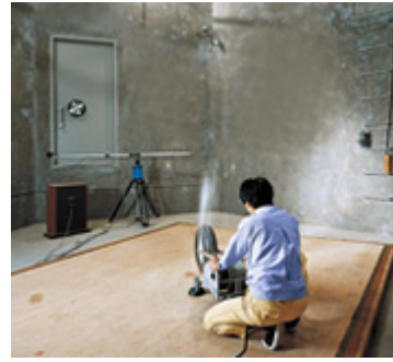
残響室で床衝撃音や遮音性能を検証
