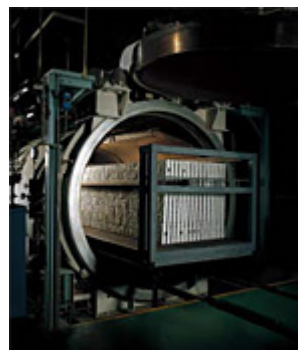
完全密封のタンクの中で高温・高圧で約20時間養生(二次養生=オートクレーブ養生)
