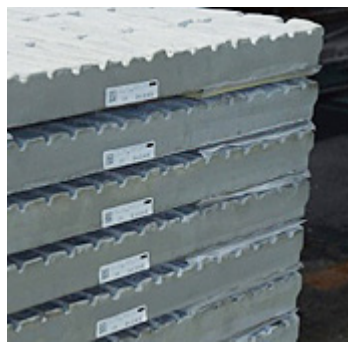
外壁パネル一枚一枚に施主コードや使用個所を表示。カスタムメイドの生産体制を完備
