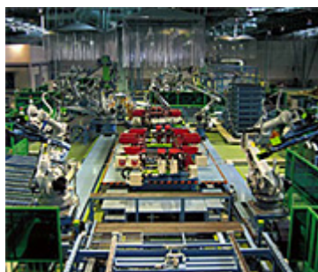
多品種の軸組を「完全邸別生産」できる自動化ラインは住宅業界初
