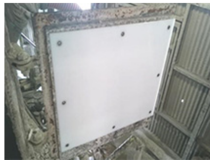
ミキサー内コンクリート付着防止
