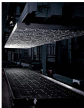
型枠に打ち込んだコンクリートを一定時間スチーム養生(一次養生)した後に脱型
