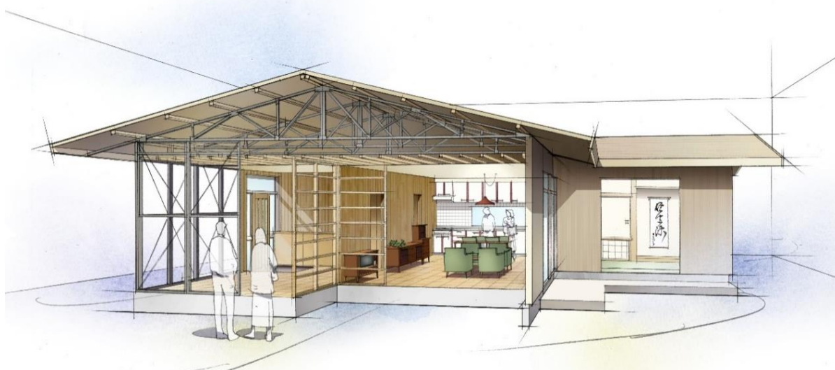
1970 年代の実物大工業化住宅（積水ハウスの軽量鉄骨住宅）
