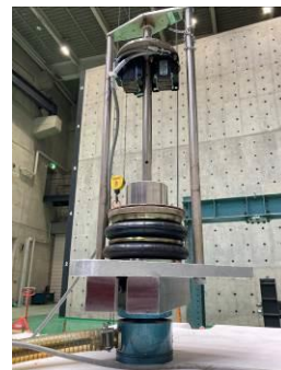
図3 落錘加振の荷重測定状況
