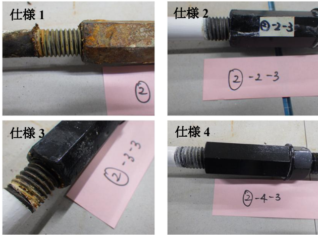
図5 塩水噴霧試験 360 時間経過後
