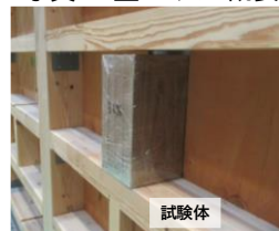
写真4 試験体挿入時の壁モデル屋内側
