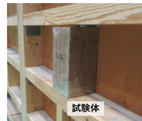
写真3 試験体挿入時の壁モデル（屋内側）
