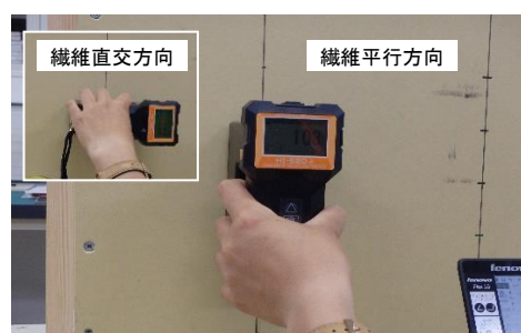
写真1 石膏ボード壁側からの計測
